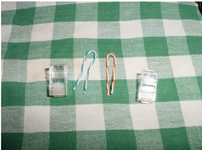
Od odrezanih Å½iÄica napravite omÄe, pokuÅ½ajte da budu jednake duÅ½ine, koje ubacite u konektore.
